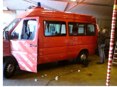
Verwijderen van de brandweer striping
